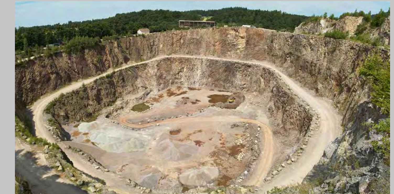
Bild 3: Blick in den Steinbruch Hartkoppe bei Sailauf im Spessart mit 1. (oben rechts) bis 6. Sohle (Mitte unten). Foto: J. Lorenz
