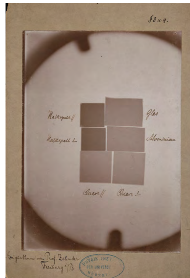
RÖNTGENAUFNAHME VERSCHIEDENER MATERIALIEN WIE GLAS, ALUMINIUM, KALKSPAT UND QUARZ
